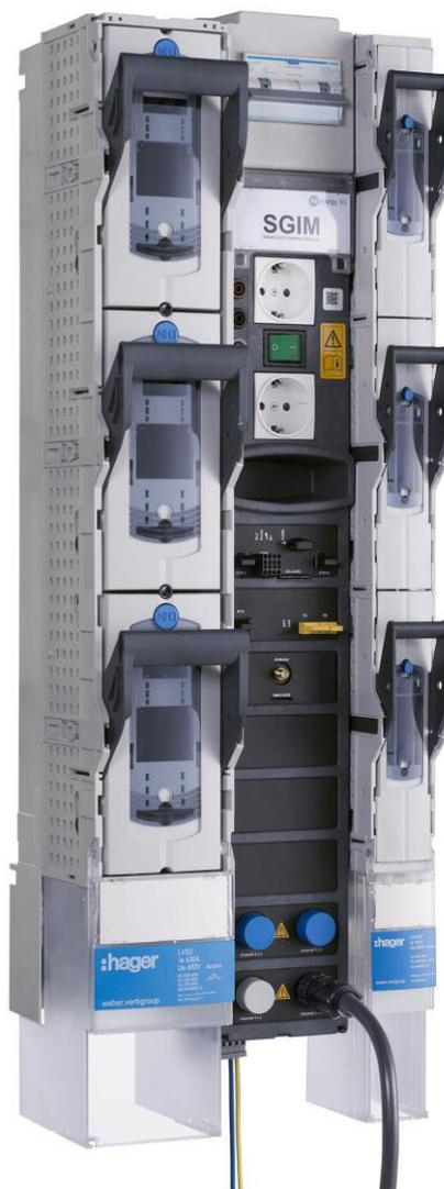
El SGIM es un sistema de medición, supervisión y control fácil-de-instalar para la digitalización de subestaciones de distribución y armarios de distribución de cables en la red inteligente. Permite una instalación rentable e ininterrumpida en el sistema de barras de 185 mm en conexión con los seccionadores de fusibles tipo tira NH de acuerdo con la norma EN IEC 61439/60947 y, por tanto, la construcción de un sistema de supervisión en los puntos y nodos críticos de la red de distribución.
