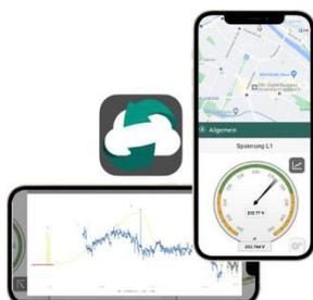
Entre otras cosas, la aplicación SGIM está disponible para la configuración in situ; la comunicación con el Smart Grid Interface Module SGIM tiene lugar entonces a través de la interfaz Bluetooth integrada. Un SGIM básicamente configurado puede ponerse en funcionamiento con los parámetros de comunicación más importantes:
